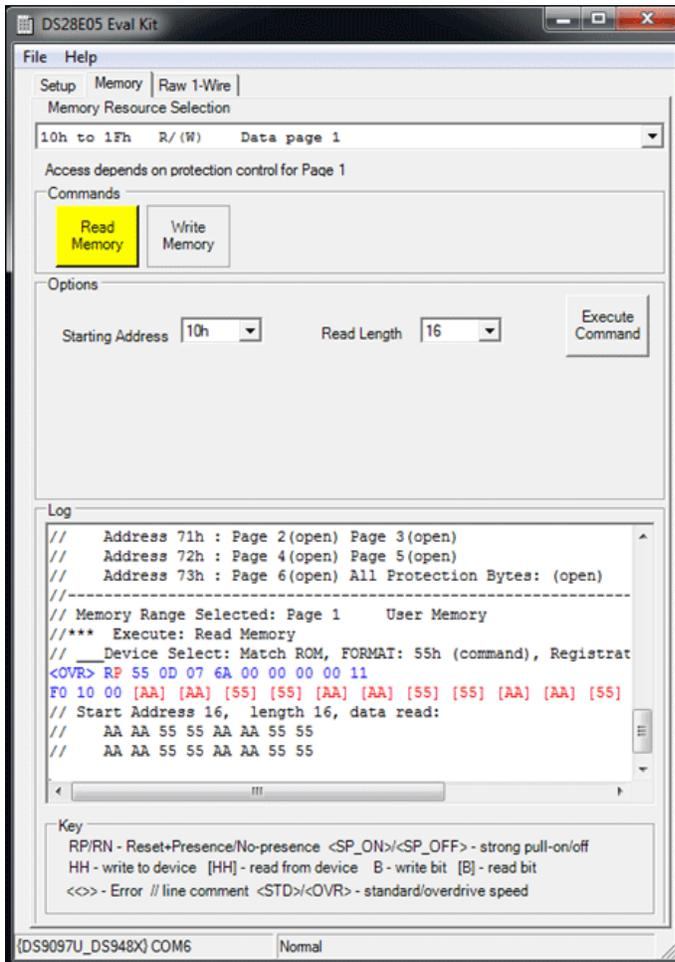
Figure 4. The DS28E05 EV kit software: main window Memory tab.
