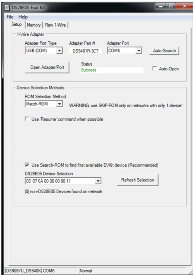
Figure 3. The DS28E05 EV kit software: main window Setup tab.
