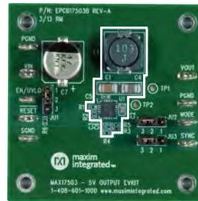
3B. MAX17503 SYNCHRONOUS BUCK CONTROLLER
